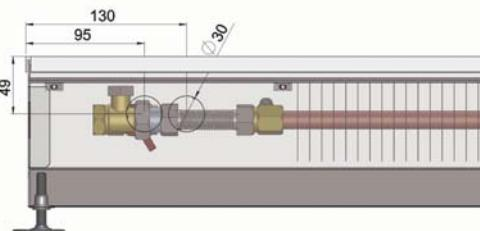
**Базовый тип внутрипольного конвектора с естественной конвекцией самой мощной серии PMW.**
