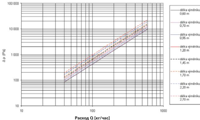
Потеря давления в восьмитрубчатом теплообменнике MINIB трубы Cu Ø 15 мм
