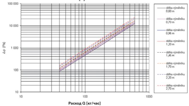
Потеря давления в четырехтрубчатом теплообменнике MINIB трубы Cu ø 12 мм
