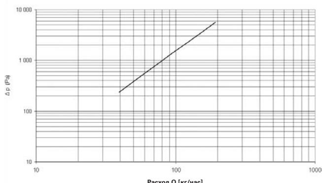
Потеря давления в нержавеющей трубке AZ 3/8" - 65 мм
