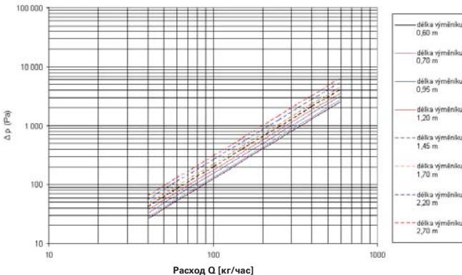
Потеря давления в четырехтрубчатом теплообменнике MINIB трубы Cu ø 15 мм
