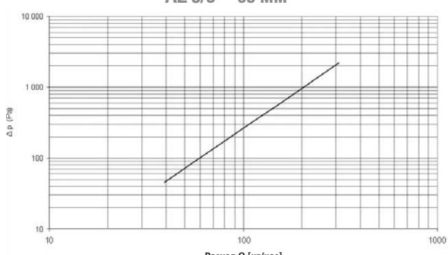
Потеря давления в двухтрубчатом теплообменнике MINIB трубы Cu ø 12 мм
