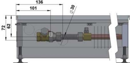
**Базовый тип внутрипольного конвектора стандартной ширины с естественной конвекцией серии РТ.**
