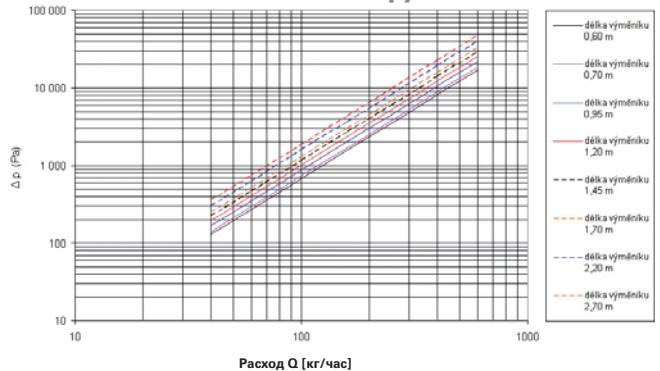
Потеря давления в шеститрубчатом теплообменнике MINIB трубы Cu ø 12 мм
