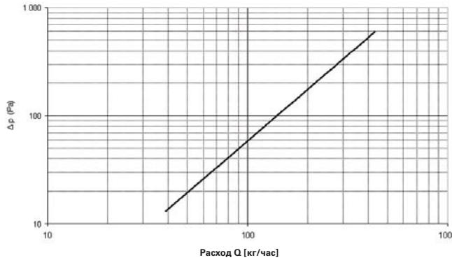
Потеря давления в восьмитрубчатом теплообменнике MINIB трубы Cu ø 15 мм
