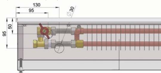
**Мощный внутривипольный конвектор с естественной конвекцией самой мощной серии PMW.**
