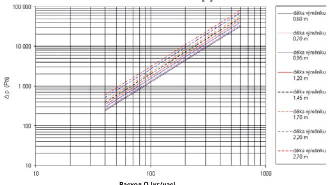
Потеря давления в восьмитрубчатом теплообменнике MINIB трубы Cu ø 12 мм
